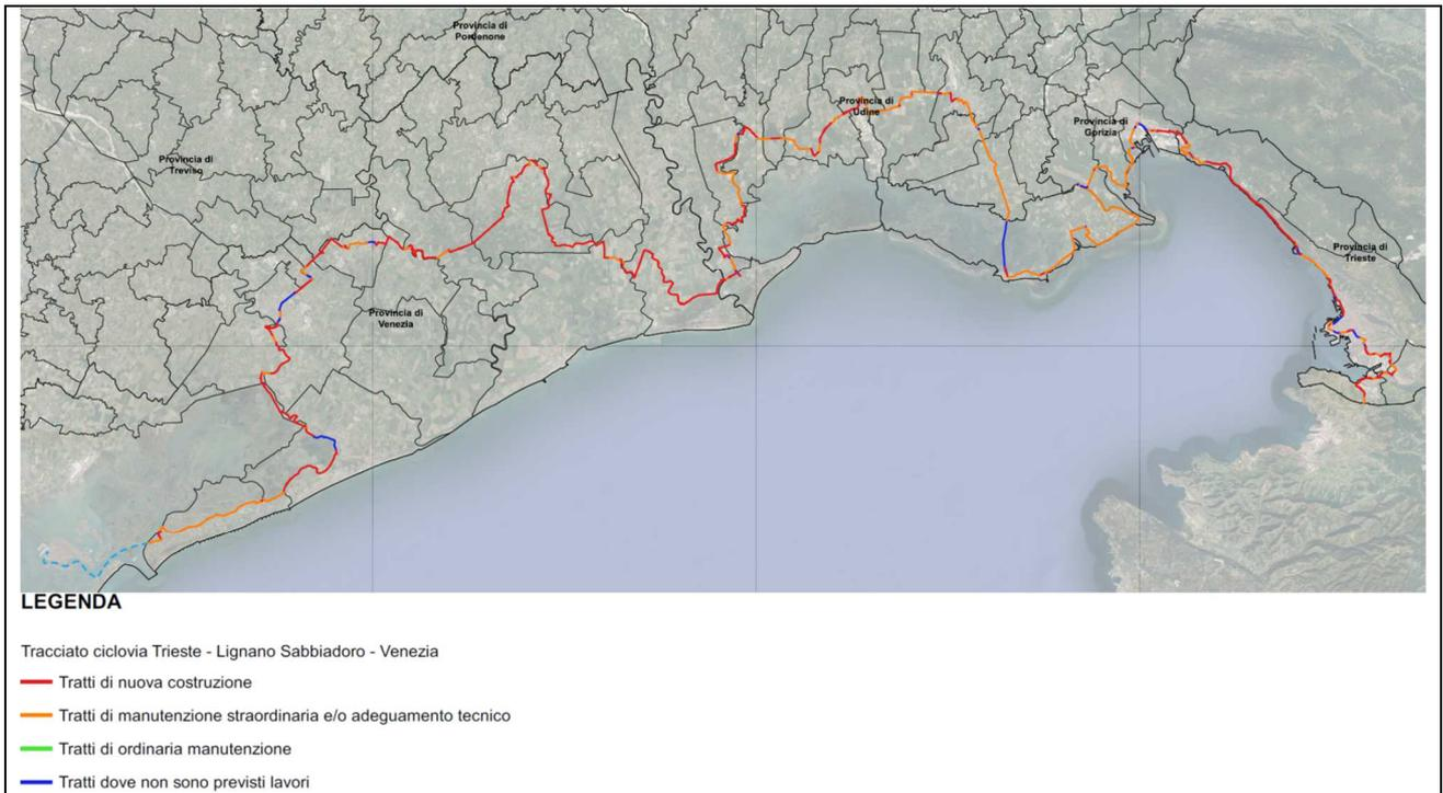
Fig. 3bis - Tipologie di intervento e stato di realizzazione (elaborato 02\_IT\_3.1\_Mappa con lo stato di realizzazione dei tratti della ciclovía\_revB.pdf)
